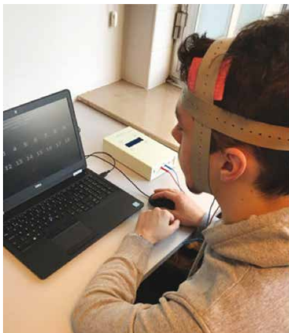
FIGUUR 2 Een opstelling voor transcraniële gelijkstroomstimulatie (tDCS)
